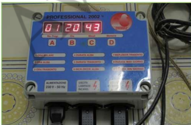
Programador de luz moderno con aumento progresivo, tiempo para amanecer, tiempo para oscurecer, luz de noche, cambio incandescente a fluorescente, etc...
