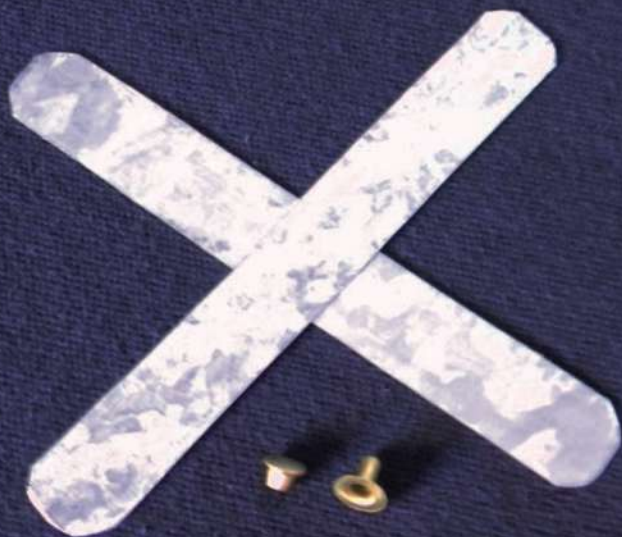
Pletinas dispuestas para su unión con remaches.
