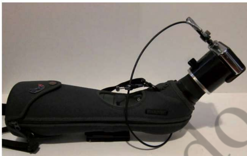
Equipo de Digiscoping formado con un Telescopio de 80mm y con un Ocular fijo de 30x. Cámara Compacta, Adaptador de 2 piezas y Cable Disparador Mecánico
